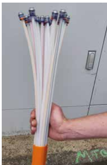
So sieht ein weißes Glasfaserbündel aus, das von der ausführenden Firma FiberBase mindestens 60 Zentimeter tief „verbuddelt“ wird.
